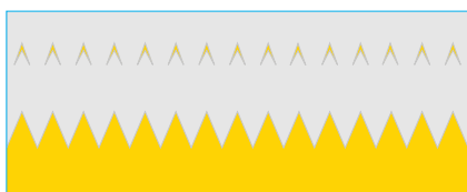
Rimbalzo del coltello e tensione del nastro troppo alta.
