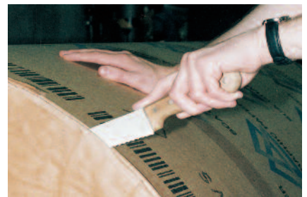
Togliere le protezioni delle estremità con un coltello a lama larga.
