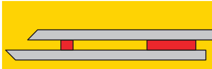
Coda di giunzione assicurata con una stretta striscia di nastro PSA.
