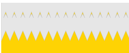
Messer "springt" oder zu hohe Bahnspannung
