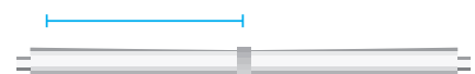
Abb. C. Bei nicht in der Mitte laufenden halben Bahnen müssen die konischen Walzen mit Klebeband versehen werden.
