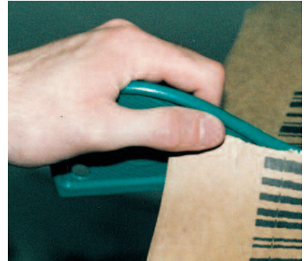
Verwenden Sie zum Entfernen der Umfangsverpackung einen Rollenschlitzer.
