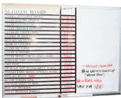
Eine Plantafel für die autonome Wartung wird von der Maschinenmannschaft aktuell gehalten und unterstützt sie bei der Festlegung der Vorrangigkeit ihrer Arbeiten. Diese werden entweder in geplanten Wartungsperioden ausgeführt oder bei kleineren Vorhaben während Maschinenstillständen. Foto QuadTech.
