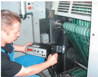
Ein Stroboskop hilft, Laufprobleme an sich bewegenden Teilen zu erkennen. Foto manroland.
