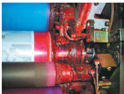
Farbansammlungen und Papierabrieb sind Hauptgründe für ungeplante Maschinenstopps und Pannen. Die Oberfläche des Schmitzrings muss saubergehalten und ständig geschmiert werden, um vorzeitigen Verschleiß zu vermeiden. Foto manroland.
