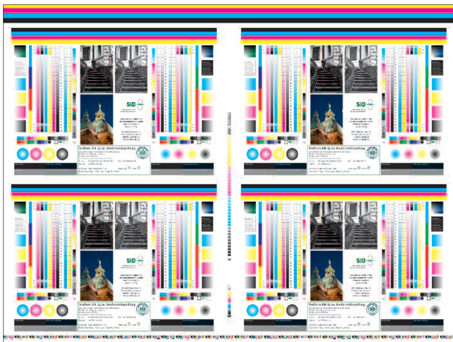
SID-Testform für den Zertifizierungsdruck (4 x SID Test-Layout auf Bogen 70 x 100 cm). Quelle: Hammesfahr
