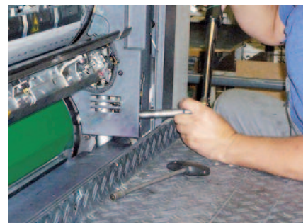
Überprüfen Sie für eine optimale Druckqualität Gummituchaufzug und –spannung. Foto: GMG
